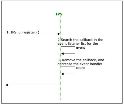
Figure 5. Onthe GPP: IPS\_unregister() control flow
